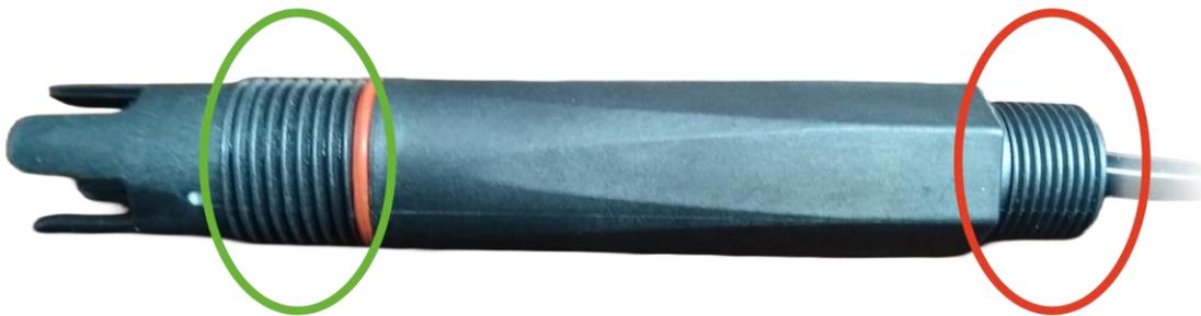
Figura 3.1 Roscas de los electrodos de pH y ORP
