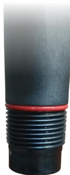
Figura 1.7 Electrodo sin tapa protectora
