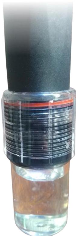
Figura 1.6 Electrodo con tapa protectora
