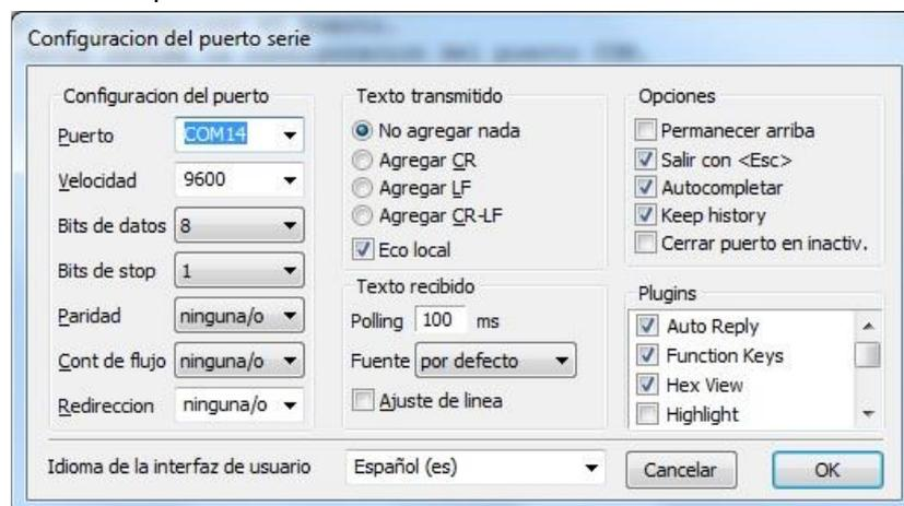
Figura 8.2 Pantalla de configuraciones del programa “Termite”
