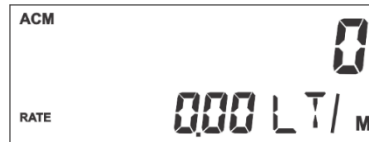
Figura 1.1 Pantalla de valor acumulado parcial o ACM y puesta a cero del mismo
