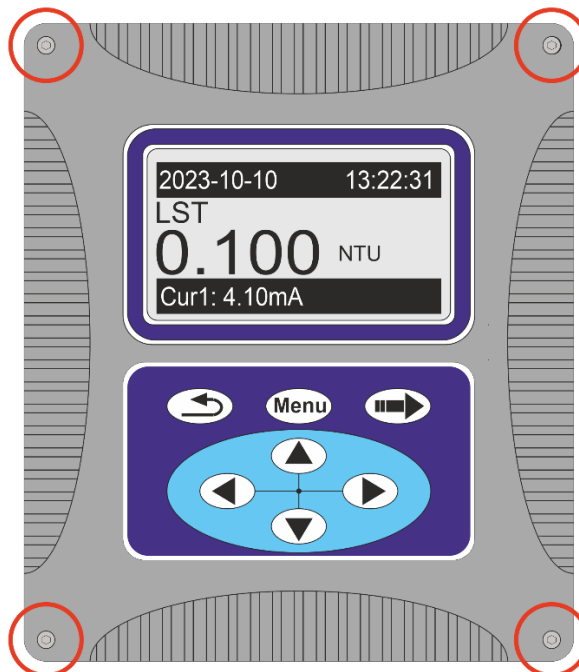
Figura 8.1 Ubicación de los tornillos de agarre de la carcasa
