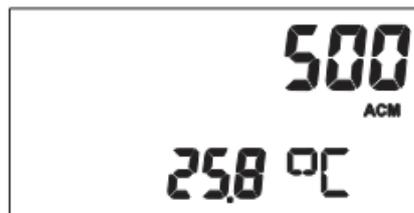
Figura 3.1. Pantalla indicadora de volumen acumulado y temperatura instantánea.
