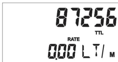
Figura 4.1 – Pantalla de TTL y RATE
