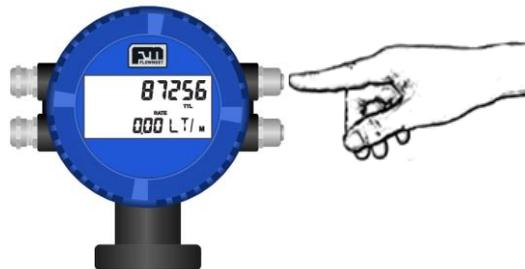
Figura 1.4. - Cambio de pantalla utilizando pulsador lateral superior.
